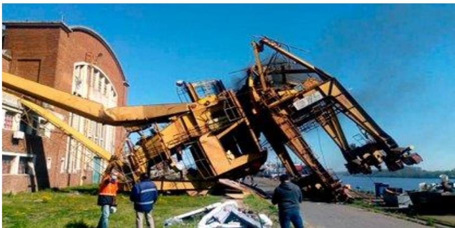
Minutos después se supo que el ensordecedor estruendo, acompañado de una fuerte vibración y una gran polvareda, se debió al desplome de una de las 8 pesadas grúas giratorias de 20 toneladas de peso y 250 toneladas de capacidad de izado que se encuentran en muelle de alistamiento de la planta industrial. La maquinaria perdió su equilibrio -según supo Infobae- en momentos en que trabajadores del astillero realizaban tareas de reparación del motor que posibilita el giro del brazo de la pluma.
