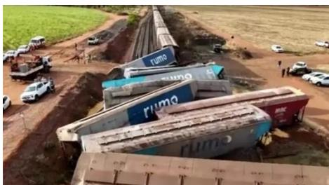
Un tren cargado con maíz se descarriló el 27 de septiembre de 2025 en Araraquara, São Paulo (Brasil), tras chocar con un camión que cruzó las vías sin respetar la señal de alto. El impacto provocó el descarrilamiento de dos locomotoras y 14 vagones, generando pérdidas materiales significativas: daños en la infraestructura ferroviaria, destrucción parcial de la carga de maíz en plena temporada de exportación, y la interrupción temporal de la logística en la Malha Paulista, una vía clave para
